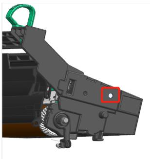
Как и в предыдущей версии, на торцевой крышке драм-юнита есть отверстие, открывающее доступ к регулятору напряжения сетки коротрона для точной подстройки плотности печати и уровня фона под используемый в аппарате тонер.»
